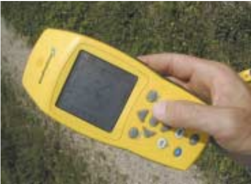
Photo n°43 : GPS utilisé dans les RN de Franche Comté. Ce modèle, avec une capacité de 1Mo, permet de stocker les données de une à deux journées de terrain. D'une précision de 1-5 mètres, il est compatible avec Map Info. Son coût est de 6 000 €. Un autre GPS est utilisé pour des relevés ponctuels (coût : 200 €).
