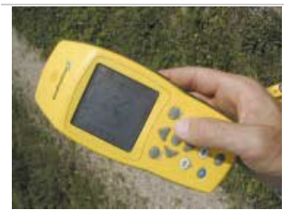
Photo n°43 : GPS utilisé dans les RN de Franche Comté. Ce modèle, avec une capacité de 1Mo, permet de stocker les données de une à deux journées de terrain. D'une précision de 1-5 mètres, il est compatible avec Map Info. Son coût est de 6 000 €. Un autre GPS est utilisé pour des relevés ponctuels (coût : 200 €). © F.TAUPIN.
