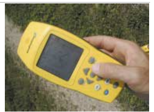
Photo n°43 : GPS utilisé dans les RN de Franche Comté. Ce modèle, avec une capacité de 1Mo, permet de stocker les données de une à deux journées de terrain. D'une précision de 1-5 mètres, il est compatible avec Map Info. Son coût est de 6 000 €. Un autre GPS est utilisé pour des relevés ponctuels (coût : 200 €). © F.TAUPIN.
