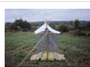
Photo n°39 : Le piège entomologique composite, développé par un universitaire, peut être fabriqué par le gestionnaire. Il a été utilisé dans la RN du Ravin de Valbois pour l'inventaire des invertébrés. © V. FIERS.
