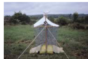
Photo n°39 : Le piège entomologique composite, développé par un universitaire, peut être fabriqué par le gestionnaire. Il a été utilisé dans la RN du Ravin de Valbois pour l'inventaire des invertébrés. © V. FIERS.
